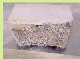
未加Concrete PowerAH 纤维的混凝土火烧后
