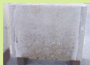
加Concrete PowerAH 纤维的混凝土火烧后
